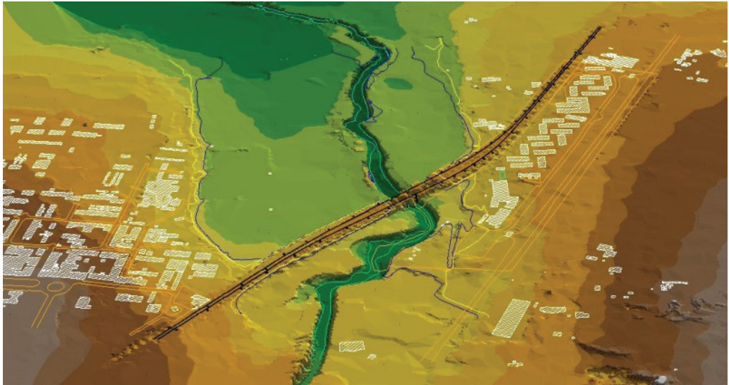
الصورة ٢. صورة بالحاسوب لنهر وخطي الفيضان لمدة ٥٠ و ١٠٠ عام (خطوط باللونين الأزرق والأصفر)، وجسر سكة حديد مزدوج الخط والبنية التحتية السطحية الموجودة بالقرب من النهر © الشركة الأفريقية للتنمية البيئية
